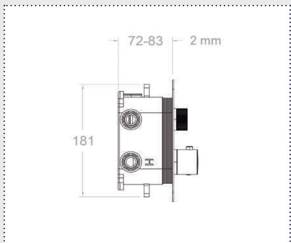
Boîtier complètement étanche qui empêche les fuites d'eau à l'intérieur du mur. Il peut être installé sur n'importe quel type de mur, par exemple, placo ou standard.
