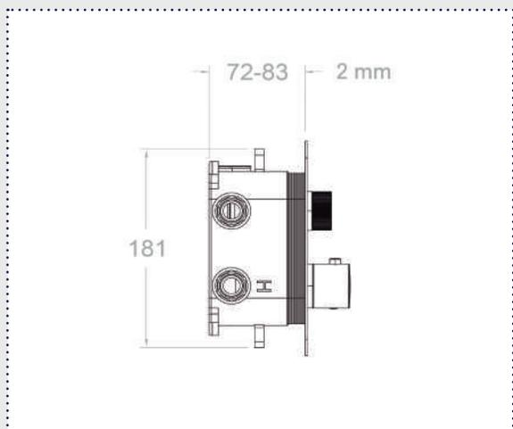
Boîte complètement étanche qui empêche les fuites d'eau à l'intérieur du mur. Il peut être installé sur n'importe quel type de mur, par exemple, placo ou standard.
