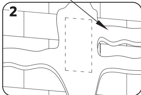
2 Realizar as ranhuras necessárias e o buraco para o alojamento da estrutura no caso da instalação embutida numa parede divisória. Prestar a devida atenção à marca que indica a que distância o espelho de acabamento deve estar nivelado (Fig.3).
