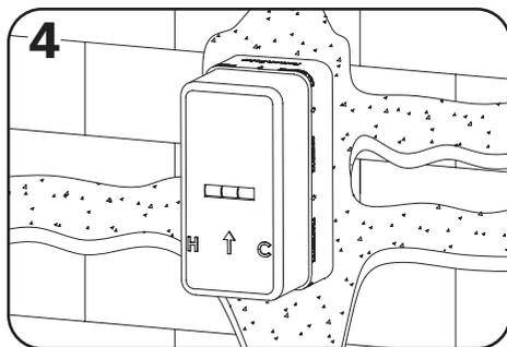
4 Depois de realizada a instalação da estrutura, preencha as ranhuras com Porex, permitindo que cubra a estrutura como forma de proteção.
