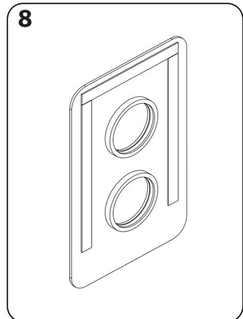
Colocar la placa escogida, según modelo y fijar mediante la cinta adhesiva.
