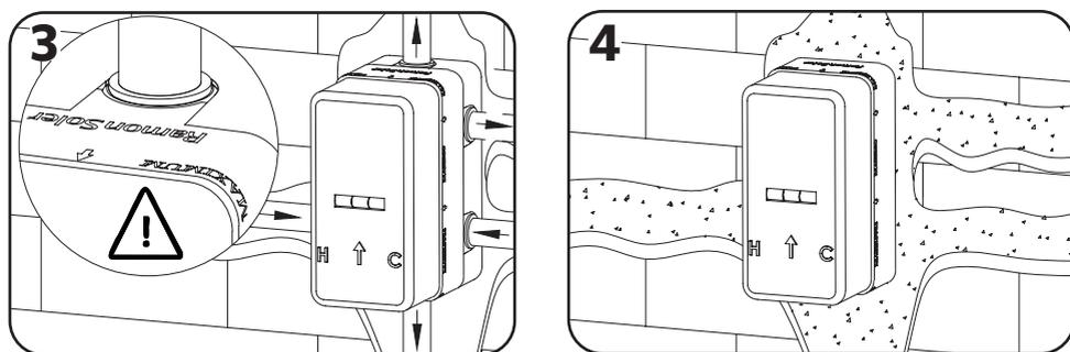
Après avoir installé le circuit, raccorder le corps du robinet encastré en s'assurant que l'alimentation en eau est coupée et le fixer aux raccords.
