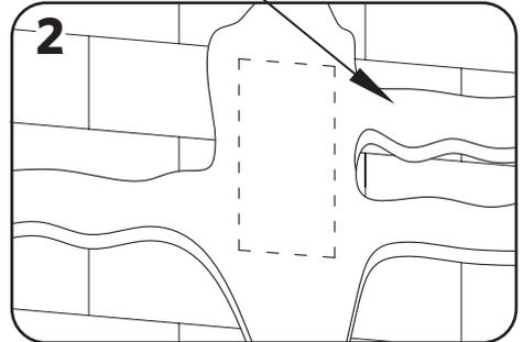
Legen Sie die nötigen Kanäle und die Wandaussparung für den Körper im Falle der Unterputzmontage.
