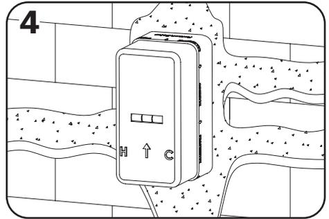
Nach der Installation des Unterputzkörpers nun die Kanäle verputzten, die Styroporabdeckung als Schutz auf dem Körper lassen.
