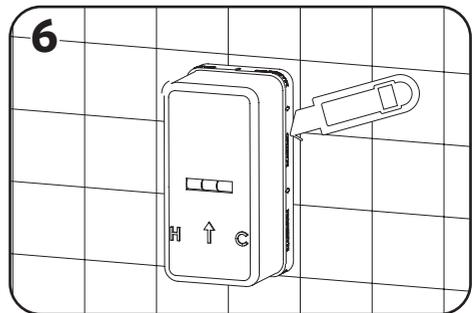
Cortar el Porex a ras del revestimiento y sellar el perímetro si fuera necesario, también tiene la opción de retirar la parte exterior del Porex por completo.
