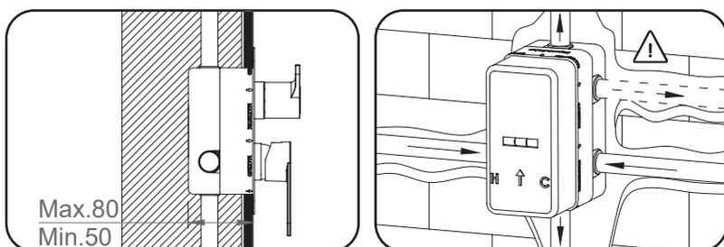
Installation sur mur de cloison
