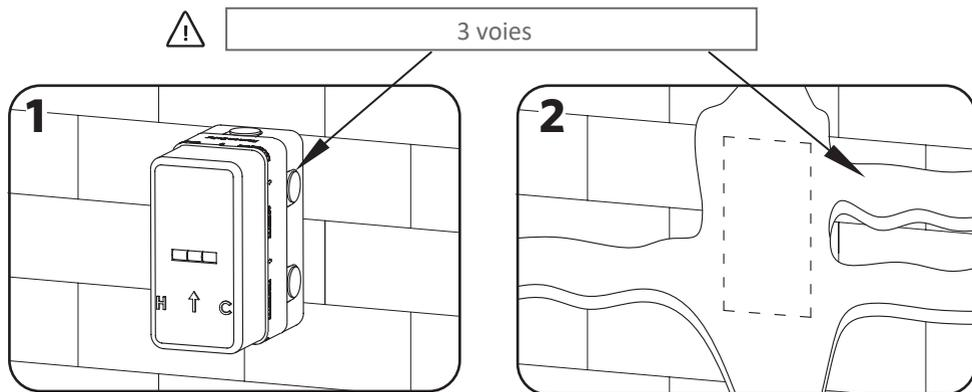
Placer le corps de l'encastable et marquer l'emplacement des raccords en vue de son installation.
