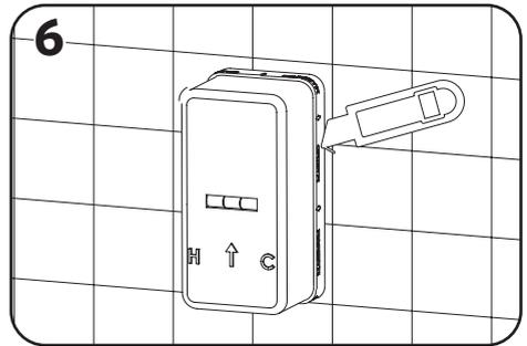
Couper le Porex au ras du revêtement et sceller le périmètre si nécessaire. Il est également possible de retirer entièrement la partie externe du Porex.
