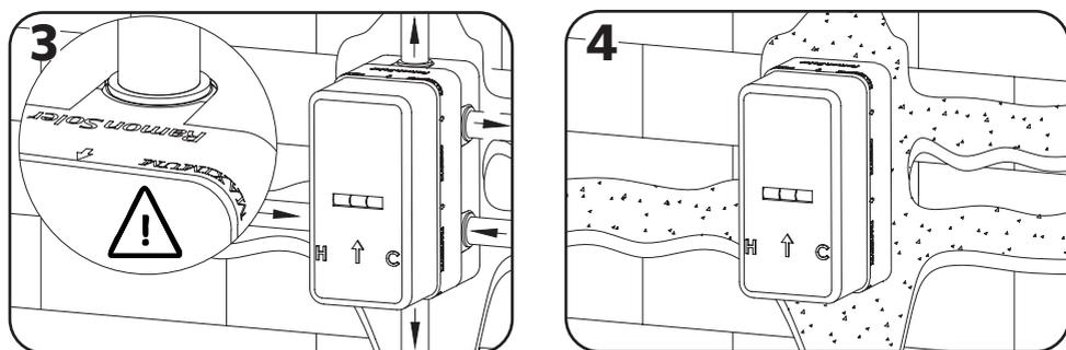
3 Una vez realizada la instalación del circuito conectar el cuerpo del empotrado, asegurándonos que la red de suministro esta cortada, éste quedará sujeto por las conexiones
