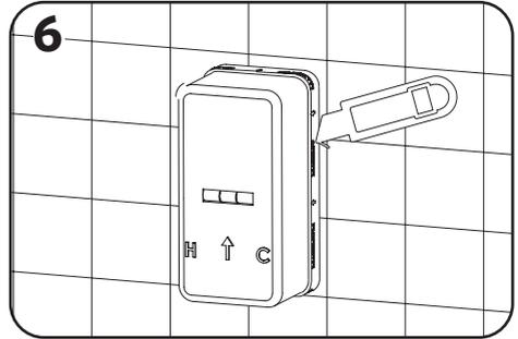
Das Styropor bündig zur Wandverkleidung abschneiden und falls nötig rundum abdichten. Es besteht auch die Möglichkeit, die äußere Styroporabdeckung komplett zu entfernen.
