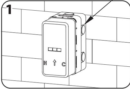
Den Unterputzkörper ausrichten und die Position der Anschlüsse markieren.
