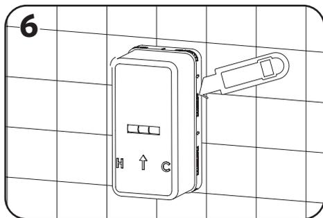
Cortar o Porex rente ao revestimento e vedar o perímetro, se necessário. Também existe a opção de retirar completamente a parte exterior do Porex.
