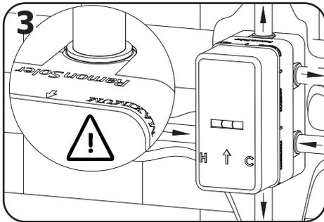
Wenn der Kreislauf bereits installiert ist, wird der Unterputzkörper bei abgeschalteter Wasserzufuhr angeschlossen und von den Anschlüssen gehalten.
