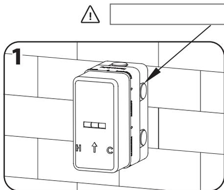
1 Posicionar a estrutura embutida e marcar o local das ligações para a respetiva instalação.
