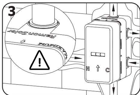
3 Depois de realizada a instalação do circuito, ligar a estrutura embutida, certificando-se de que a fonte de alimentação está cortada. A estrutura ficará suportada pelas ligações.
