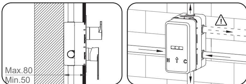
Installation encastrée sur mur en brique ou ciment
