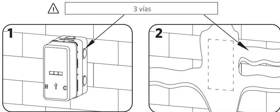
1 Posicionar el cuerpo del empotrado y marcar la ubicación de las conexiones para su instalación.
