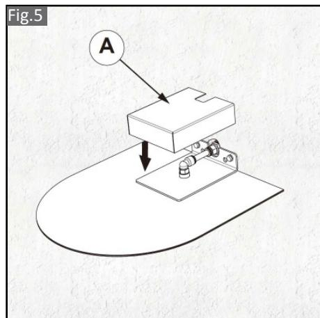
(ES) Verificar el sellado hidráulico de la unidad y volver a colocar la caja protectora (A)
