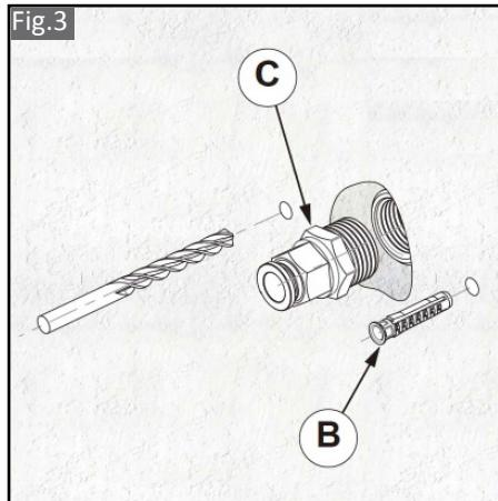
(ES) Taladrar los agujeros previamente marcados, utiliza la broca específica en función al tipo de pared y al taco que se vaya a utilizar (incluido taco metálico Ø10mm y M6)
