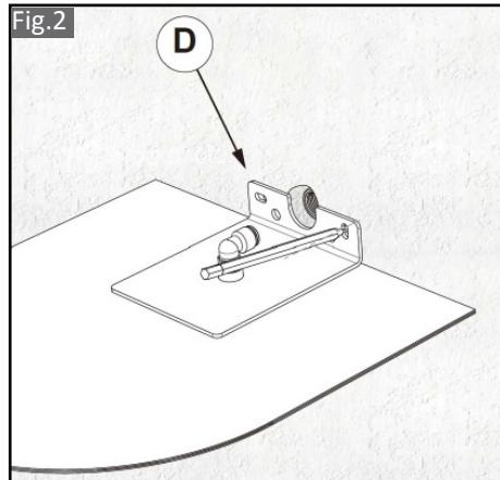
(ES) Posicionar la placa (D) en la pared prestando atención a que la conexión quede centrada.
