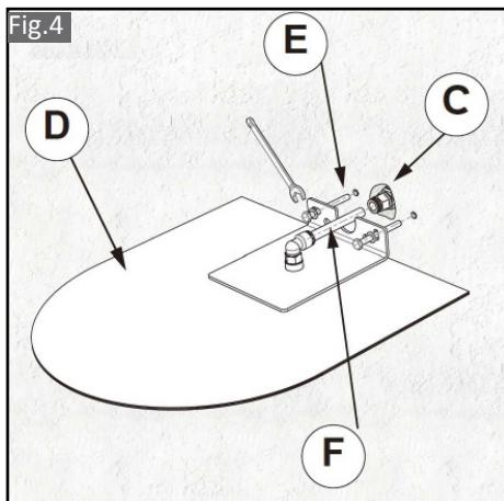
(ES) Colocar el tubo flexible (F) al racor (C). Posicionar el rociador (D) alineándolo con los taladros previamente hechos y roscar los tornillos suministrados (E) para fijar el conjunto.
