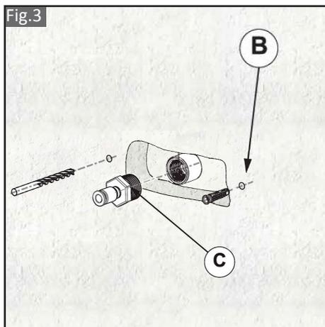
(ES) Roscar el r acord (C) a la conexi n G1/2". Para una correcta instalaci n, la parte hexagonal del r acord debe quedar a ras de la pared.
