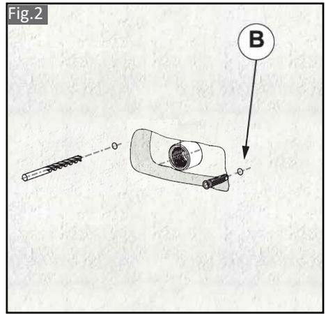
(ES) Taladrar los agujeros previamente marcados, utiliza la broca específica en función al tipo de pared y al taco que se vaya a utilizar (incluido taco metálico Ø10mm y M6) Introducir los tacos en los agujeros (B)
