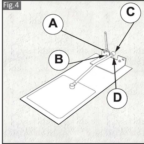
(ES) Fije la placa a la pared sin apretar los tornillos al máximo (A). Ayúdese de los tornillos prisioneros (B) para el posicionamiento correcto del rociador, cuando este en la posición correcta apriete los tornillos (A) al máximo.
