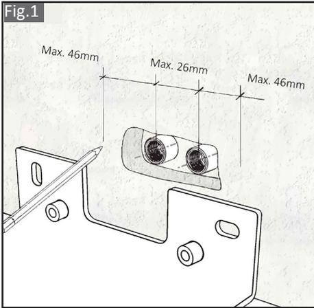
(ES) Prestando atención a los centros de las conexiones G1/2", marcar la posición de los taladros.
