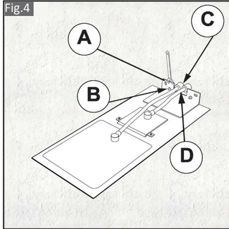
(ES) Fije la placa a la pared sin apretar los tornillos al máximo (A). Ayúdese de los tornillos prisioneros (B) para el posicionamiento correcto del rociador, cuando este en la posición correcta apriete los tornillos (A) al máximo. Antes de conectar los tubos de alimentación (D) al racor (C), medir correctamente y cortar el sobrante de la conexión si fuera necesario.
