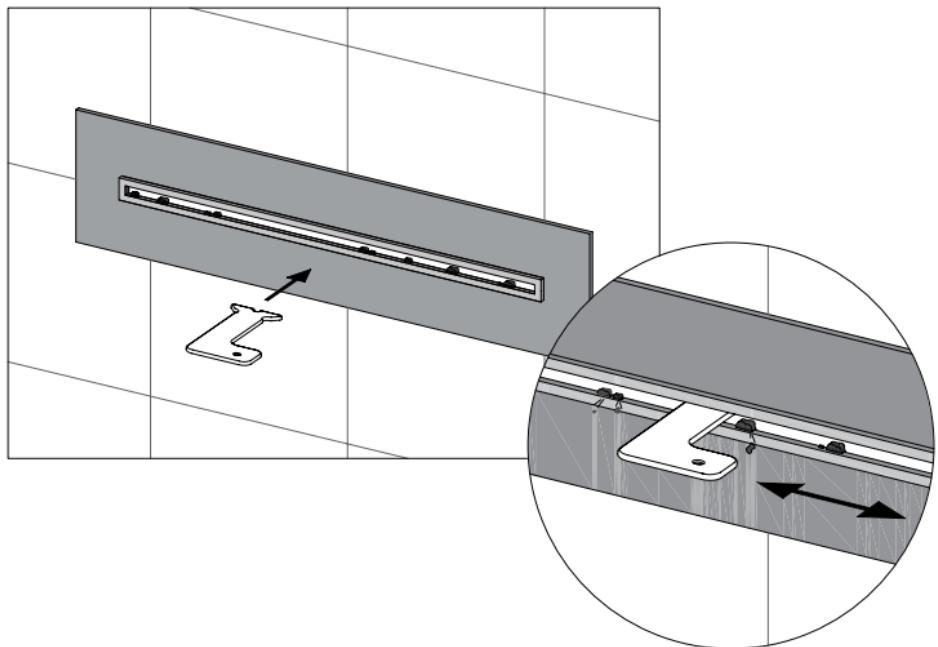
Si observa que el caudal de su cascada es irregular o esta fragmentado puede ser debido a la acumulación de restos de cal en la salida del agua. Utilizar la herramienta suministrada introduciéndola en la ranura y moviéndola de manera horizontal para retirar las impurezas.
