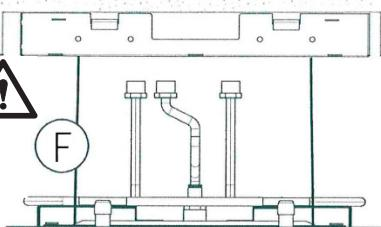
(ES) En ambas opciones de instalación, antes de realizar las conexiones hidráulicas, acoplar el rociador empotrado con el marco mediante los cables de seguridad (F) y purgar la instalación.
