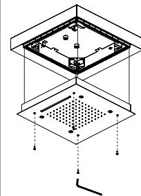
(ES) Completar la instalación del rociador mediante la realización de las conexiones hidráulicas. Colocar el filtro (5) y el limitador (6) entre la conexión flexible (7) y el rociador Fig.5. Compruebe el sistema hidráulico y a continuación fije el marco con los tornillos en sus asientos Fig.6.
