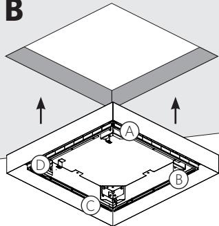
(ES) Hacer el recorte en el falso techo correspondiente a las medidas del marco interior del rociador. Hacer los taladros al techo de obra para colocar las varillas (3). Utilizar los tacos adecuados según el tipo de material del cual sea la superficie a taladrar.
