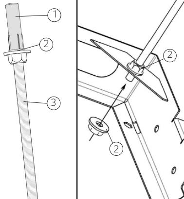
(ES) Fijar el marco del rociador mediante el kit de montaje compuesto por las varillas (3), tuercas (2) y tacos (1), tal y como se observa en las imágenes. Cortar las varillas si fuera necesario. La Fig.3.3 corresponde a la zona superior de la varilla que va fijada al techo y la Fig.3.4 corresponde a la fijación del marco.
