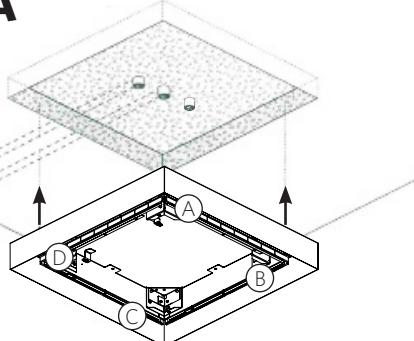
(ES) Para la instalación en **techo de obra**, fijar mediante tornillos en las ranuras (A, B, C y D).
