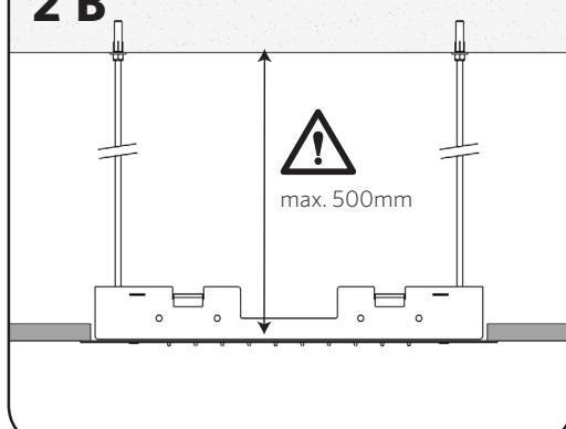
(ES) En el caso de la instalación en **falso techo** utilizar el kit de fijación, compuesto de varillas y sus accesorios (1, 2, 3).
