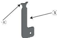
(ES) HERRAMIENTA PARA LIMPIEZA DE CASCADAS. Si el flujo de su cascada es irregular/fragmentado, es posible que se haya depositado alguna piedra caliza a lo largo del tiempo, debido al uso frecuente del producto y/o el agua, que es particularmente dura o rica en piedra caliza. Use la herramienta (5), insertando las pestañas (6) en el pico de la cascada y moviéndose horizontalmente (derecha e izquierda) para eliminar cualquier depósito de piedra caliza.
