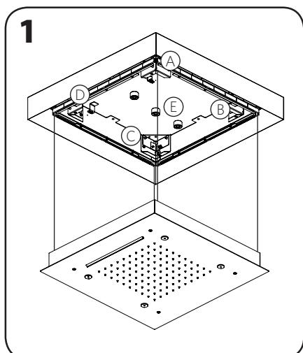
(ES) Para una correcta instalación es necesario tener en cuenta sobre que superficie vamos a colocar el rociador. El sistema de agua (E) debe estar centrado en el marco, y el borde inferior alineado con la superficie visible del techo. Desmontar cables y tornillos.
