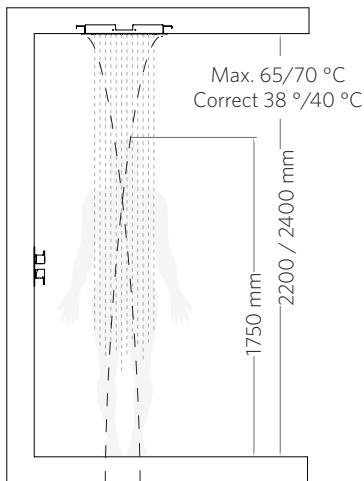
(ES) El cabezal de ducha tiene un limitador de flujo de 9 l/min. Para un funcionamiento óptimo requiere una presión de agua de 3 bar y un flujo total de 15 l/min. Una presión (6 bar máx) y flujo diferente influirán en el efecto de la lluvia pero no en la funcionalidad del cabezal de ducha.
